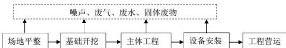
图 2.3-1 污水处理厂施工流程图
